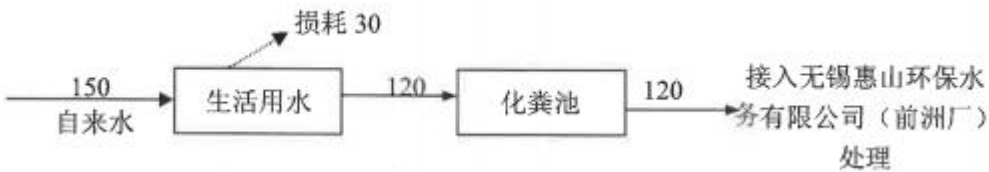
图 2-3 全厂水平衡图 单位：t/a
